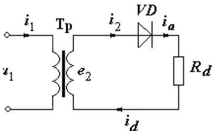
А: двухполупериодного мостового; Б: двухполупериодного с выводом средней точки обмотки трансформатора; В: однополупериодного; Г: трехфазного однополупериодного. Ответ: В.
